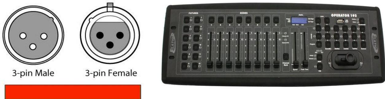
Bild 2.5. Links: Ein DMX-Anschluss für die Lichtsteuerung, welcher stecker- und kabelmässig dem XLR-Standard für Professional Audio entspricht (es lassen sich also Lichtanlagen mit denselben Kabeln wie Professional Audio verbinden). Rechts: Ein DMX-Lichtmischpult
